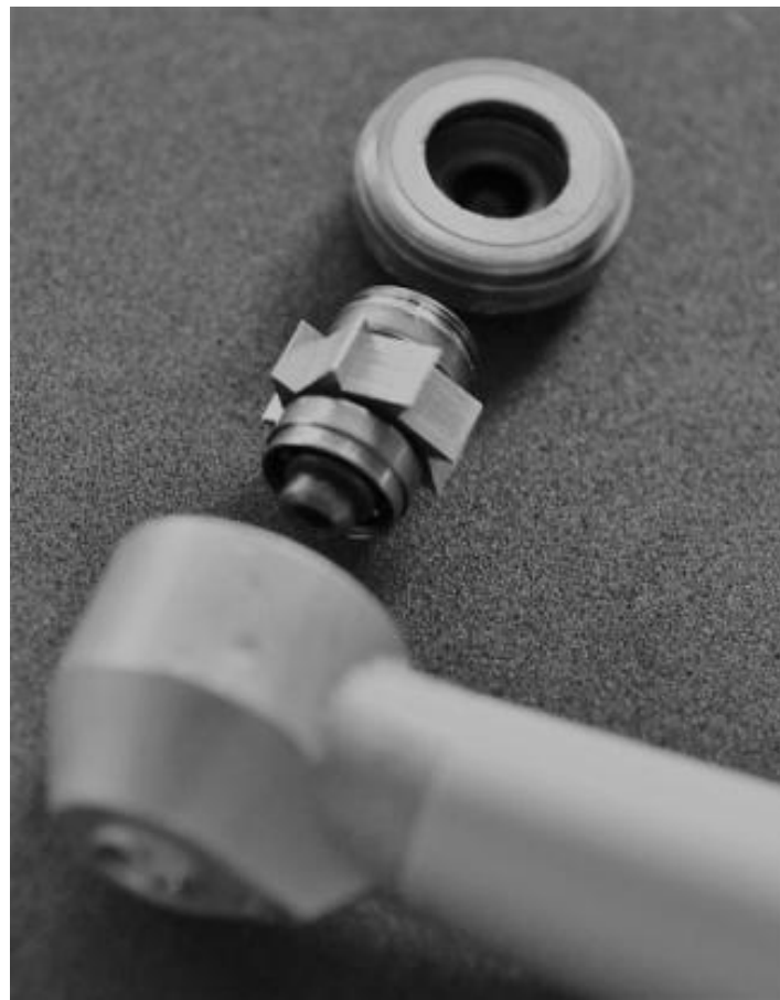
Interior del Cabezal de una Turbina
